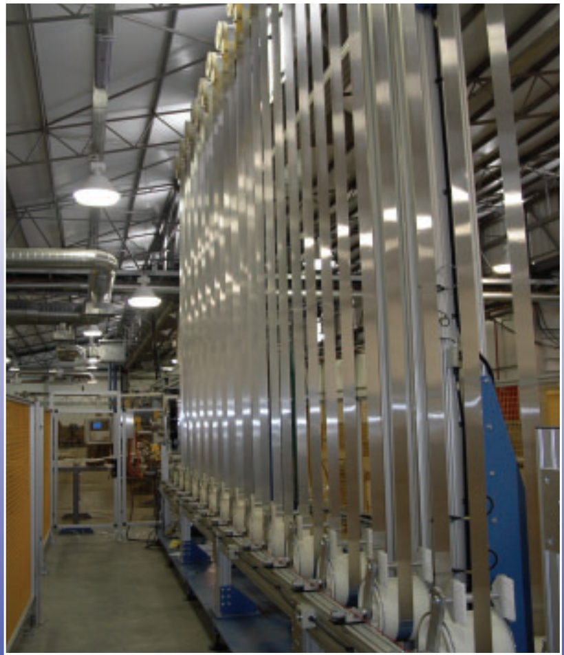
הקו המתקדם החדש לייצור מולטיגול פקס-אלומיניום-פקס
